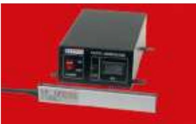
El sistema consta de un generador de estática y una o más Barras. El generador produce una corriente directa de hasta 30kV. La Barra 7080 emite esta corriente en forma de una nube de iones. Los materiales pasan a través de esta nube de iones y se cargan de la misma polaridad que el generador en el lado de la barra, con una imagen de carga espejo en el lado opuesto, producida por la tierra.
